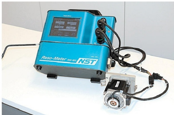
レゾルバとモーターの位相差を計測し、容易に角度調節できる「レゾメータRM-100」
