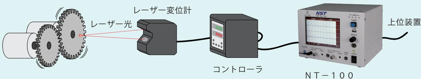
レーザー変位計から出力されるレーザー光を、ギヤの決まった位置に照射して異音のレベルを計測します。
