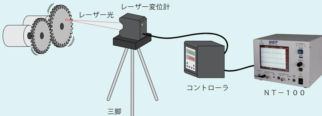
レーザー変位計から出力されるレーザー光を、ギヤの任意箇所に照射して異音のレベルを計測。レーザー光の照射位置を変えることで、ギヤ部位による異音の発生箇所を特定することができます。
