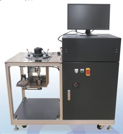
独自の機構設計により 外部駆動源のコギングトルクを抑えた 正確な測定が可能
