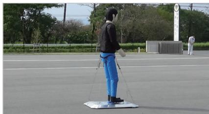
台車上に歩行者やサイクリストのVRU (Vulnerable Road User: 交通弱者) を搭載し路面を自由に走行します。
